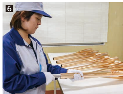
6 燃焼部が正しく取り付けられるか、内径の確認をしている様子
