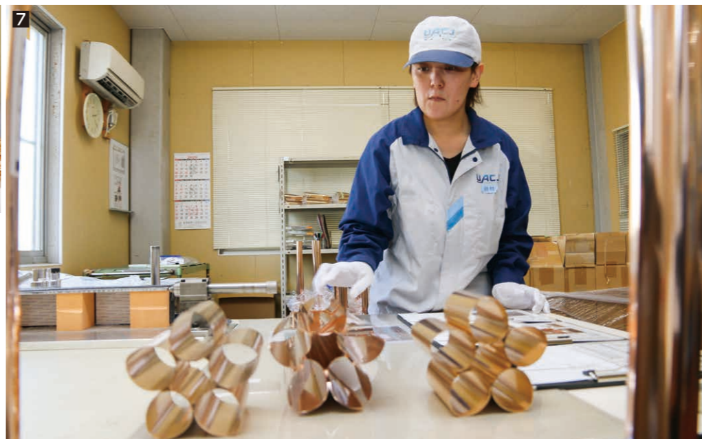
6 燃焼部が正しく取り付けられるか、内径の確認をしている様子
