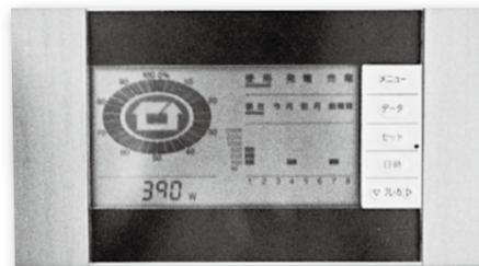
▲現在の電力消費量や発電量を表示する太陽光発電システムのエネルギー表示器
