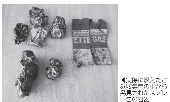
▲実際に燃えたごみ収集車の中から発見されたスプレー缶の容器
