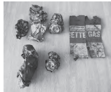
▲実際に燃えたごみ収集車の中から発見されたスプレー缶の容器
