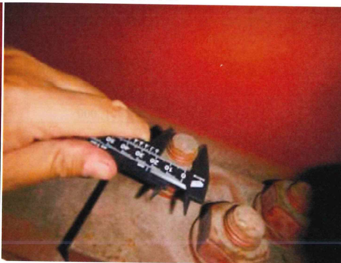
ボルト径測定状況
