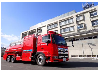
伊勢崎消防署配備 伊勢崎水槽1号車 (小型動力ポンプ付水槽車)
