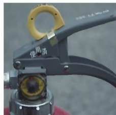
× 表示装置の脱落
