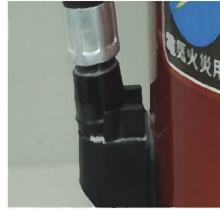
× 消火薬剤の漏れ
