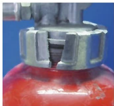
× キャップの破損
