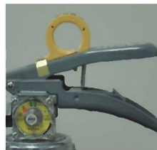
× レバー支えの脱落
