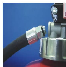
× 緊結ネジの破損 × ホースの脱落
