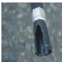
× ノズルの破損
