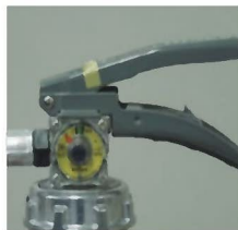
× 安全栓の脱落
